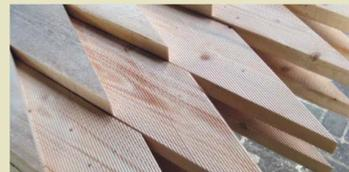
Im nächsten Schritt werden zunächst die Einzeltei- le der Holzrahmenbau-Elemente wie Stiele, Rähme, Schwellen sowie Balken und Sparren als Einzelteile hergestellt und nummeriert. Modernste Technik, wie z. B. eine Abbundanlage, ermöglicht **präzise Schnitte für die Verbindungen der Holzbauteile.** So passt beim Aufstellen des Hauses alles perfekt ineinander.
