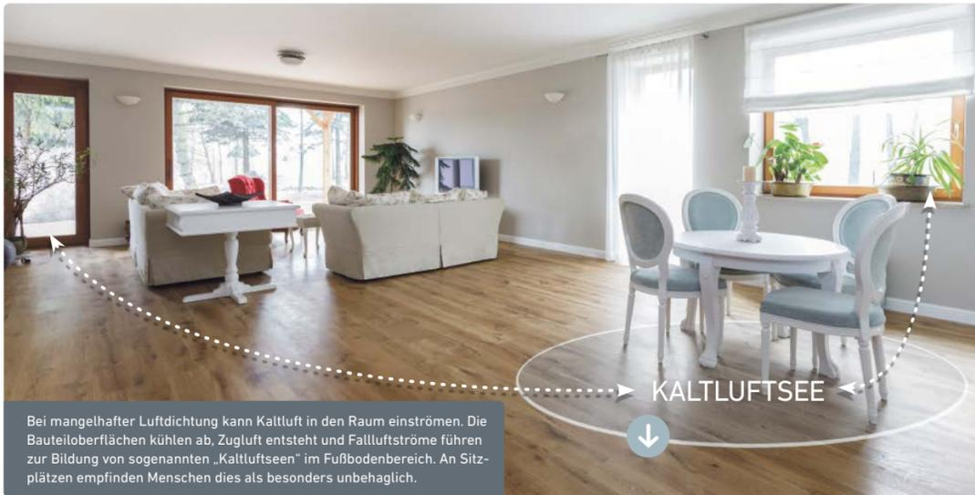
Bei mangelhafter Luftdichtung kann Kaltluft in den Raum einströmen. Die Bauteiloberflächen kühlen ab, Zugluft entsteht und Fallluftströme führen zur Bildung von sogenannten „Kaltluftseen“ im Fußbodenbereich. An Sitzplätzen empfinden Menschen dies als besonders unbehaglich.
